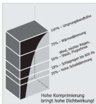
Die Auflage des Compriband-Kombi, i.e. das geschlossenzellige Comprilen, soll an eine glatte Oberfläche drücken (Metall o.ä.), um optimale Dichtwirkung zu erzielen. Somit schließt das Comprilen mit dem Metall ab, wobei das offenzellige Compriband-A auf rauen und glatten Untergründen aufgeklebt werden kann.
